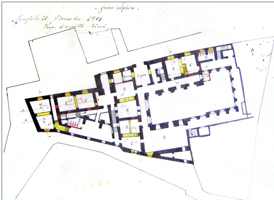
Fig. 44. Progetto per la trasformazione dell'ex convento dei SS. Giuseppe e Anna ad uso di Scuola primaria femminile. Pianta del piano inferiore (A.S.C.M.).
